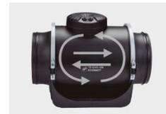
Durch drehen der **Motoreinheit** kann die Luftrichtung geändert werden, ohne die Montagekonsole zu demontieren.
